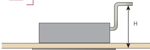
В сплит-системах канального типа ARHG12-18LLTB и ARHG12-54LHTBP дренажный насос также идет в комплекте с внутренним блоком и не требует дополнительного монтажа.
