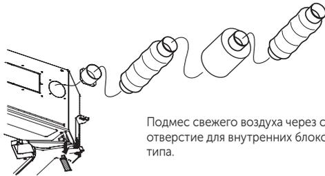
Подмес свежего воздуха через стандартное отверстие для внутренних блоков кассетного типа.
